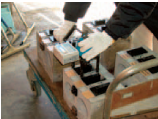
写真7 付着強度試験状況
