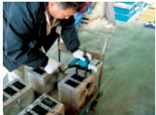
写真8 付着強度試験状況
